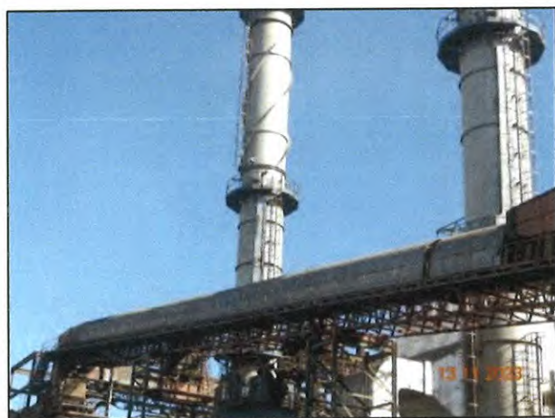
รูปที่ 7 ระบบสายพานลำเลียงแบบปิด
