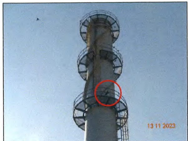
รูปที่ 2 ระบบตรวจวัด Oxygen Analyzer Sensor
